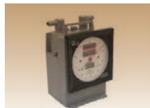
带复位计数器的 干式气体流量计 Dry Gas Meter with Resettable counter
